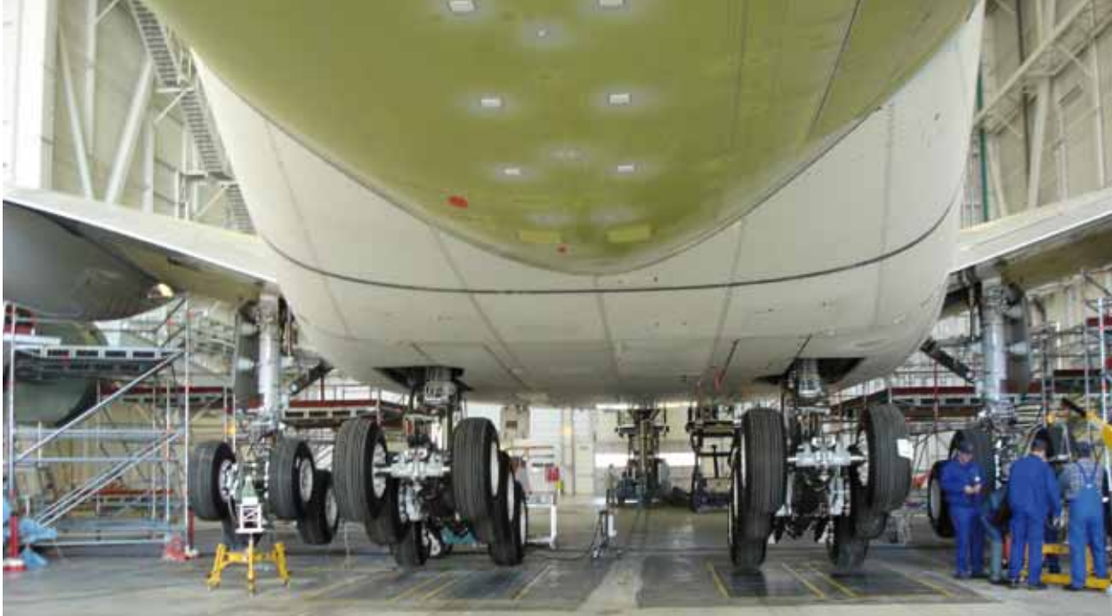
Airbus Standschwingversuche zur Ermittlung des Belastungsverhaltens der Flügel
