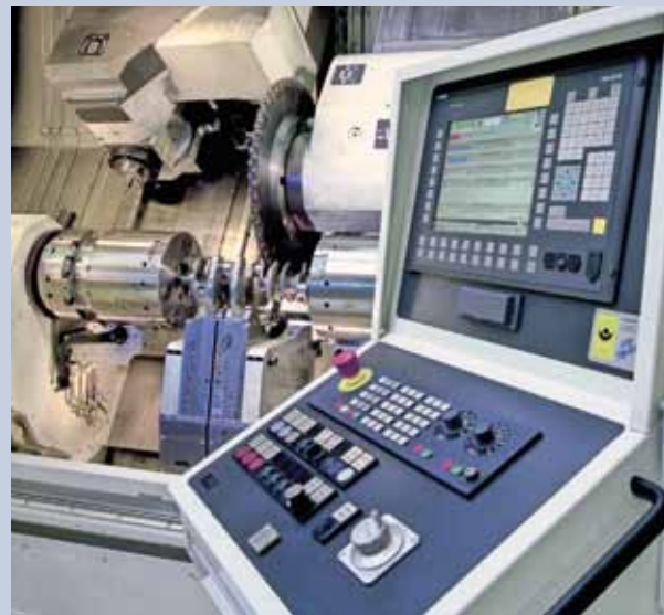
Plug & Prognose: Prototyp-Software ermittelt über Sensoren den Betriebszustand einer Maschine und erstellt bei Änderungen neue Analysemodelle.
