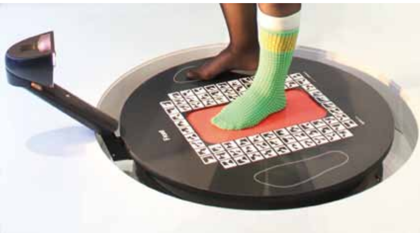
Digitale Kundeninteraktion: Erfassung von Fußform und Druckverteilung für eine orthopädische Laufoptimierung.
